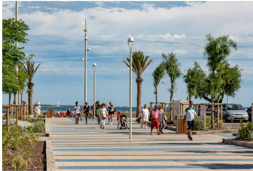
Les Ceramic sont équipés de luminaires LED Magic de Technilum (3 000 K, DALI). Les optiques sont en majorité symétrique mais également Asymétrique Wide Beam (WB) et Asymétrique Medium Beam (MB).
